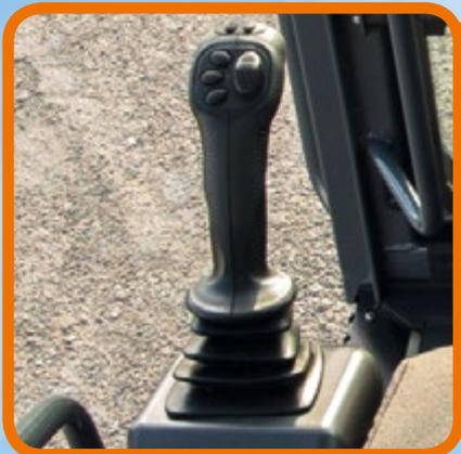
**Système de commande hydraulique indépendant**
